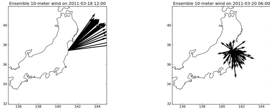
FIGURE 2: Prévisions à la centrale de Fukushima de la vitesse et de la direction du vent à 10 mètres par plusieurs modèles météorologiques issus de **TIGGE**. À gauche, une incertitude significative est observée (cas classique) ; à droite, l'incertitude est particulièrement élevée, ce qui conduit à de très fortes erreurs dans la simulation de la dispersion des radionucléides.
